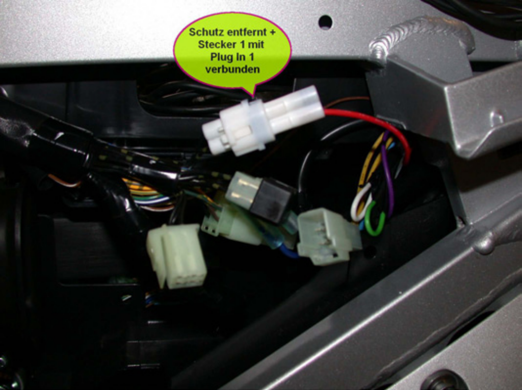
Bild 2: Den Blindstopfen entfernen und durch das passende Plug In ersetzen.
