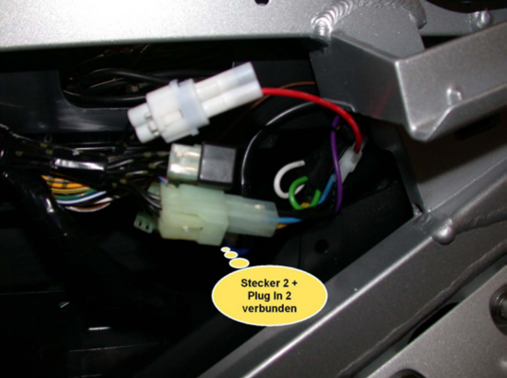
Bild 3: Die Stecker miteinander verbinden – fertig, fast fertig!
